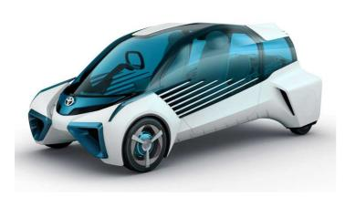
トヨタ自動車の目玉は、昨年末発売した燃料電池車「ミライ」を発展させた試作車「FCVプラス」だ。水素エネルギーが家庭に普及した十数年後をイメージし、FCVに搭載された水素を使う発電機を取り外して持ち運べるようにし、家庭用の発電機としても使えるようにした。「走っていない時でも社会に役立てる」と開発担当者は言う。
